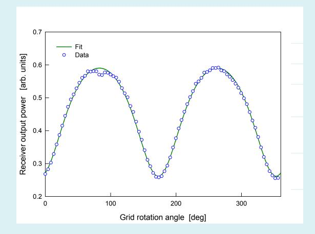
Frequency: 100 GHz  $T_{hot}$ : 300 K  $T_{hot}$ : 80 K
